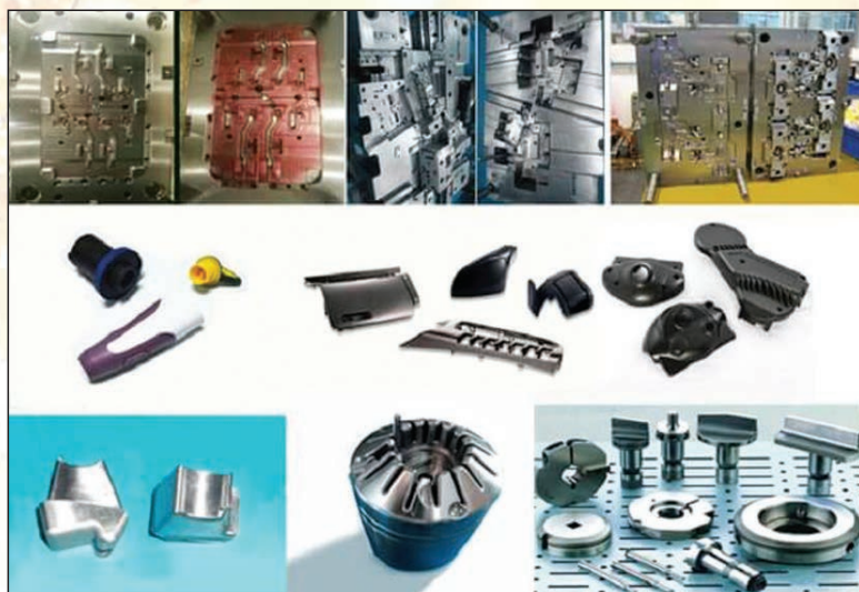
Hình 2. Khuôn mẫu đa dạng được sản xuất bằng công nghệ CNC
