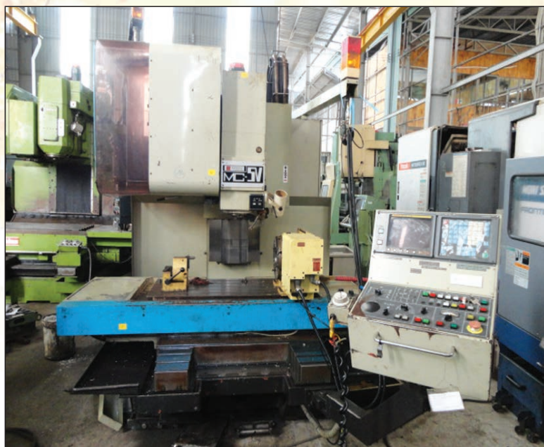
Hình 4. Máy Phay CNC làm khuôn mẫu hiệu WASINO MC-5V Nhật Bản
